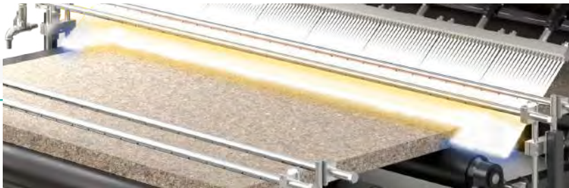
Multi Fire Nozzles and water cooling system Multi Ugelli con sistema di lavaggio e raffreddamento
