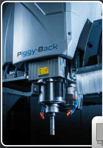
Piggy-Back è un sistema integrato per eseguire lavorazioni con utensili, prevede un elettromandrino ATC (automatic tool change) con attacco ISO40, posizionato in verticale accanto al motore principale per disco dotato di un ulteriore attacco per utensile.
