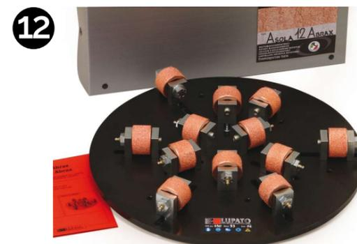
Asola 6 ed Asola 12 devono essere applicate su levigatrici automatiche per la lavorazione delle filagne e devono essere utilizzate senza il movimento del ponte.
