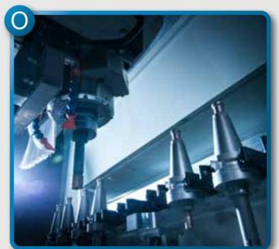
**THE NEW ADDITIONAL SIDE SPINDLE PIGGY-BACK WITH AUTOMATIC TOOL CHANGER**
