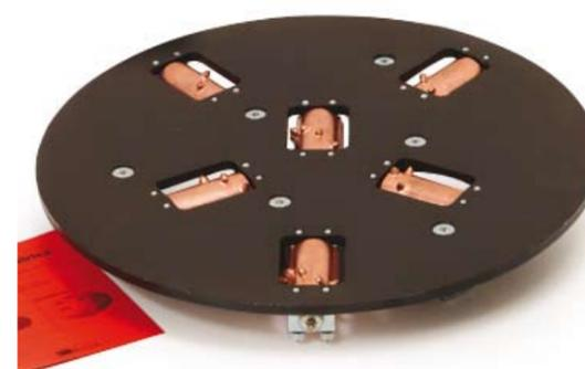
Rotospuntatrice 6 può essere applicata su levigatrici automatiche per la lavorazione delle lastre o delle filagne.
